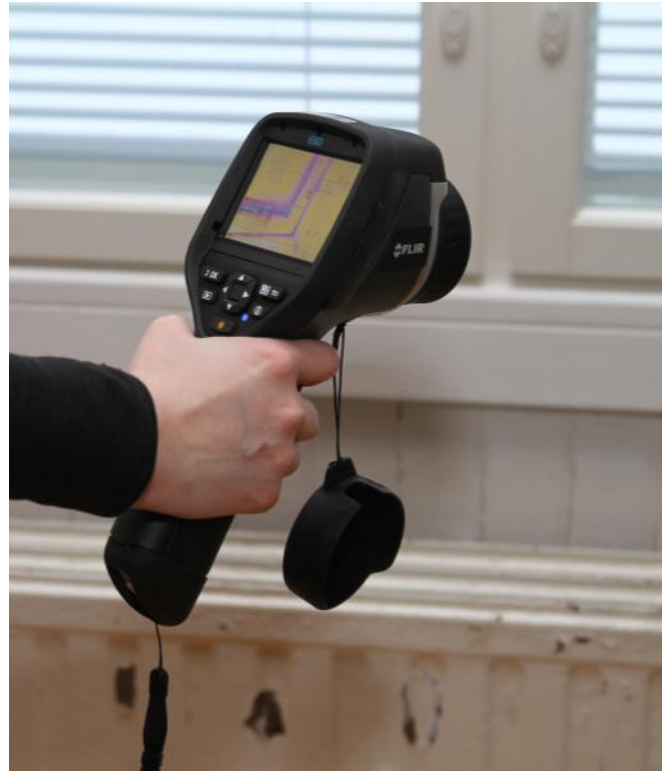
Lämpökameran avulla on helppo havaita ikkunoiden vuotokohdat.
