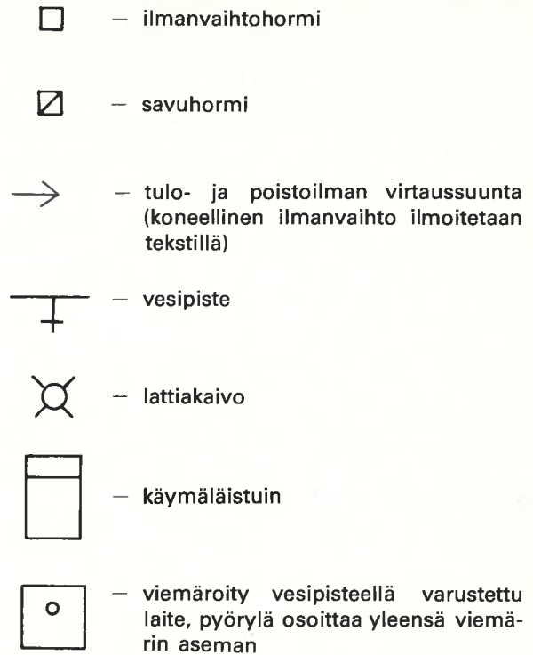
Kuva 5 Lämpö-, vesi- ja ilmanvaihtoteknilliset yleismerkinnät pääpiirustuksissa
